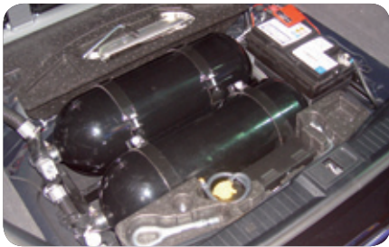
Depósito de Hidrógeno líquido (cedida por Robotiker Tecnalia).
