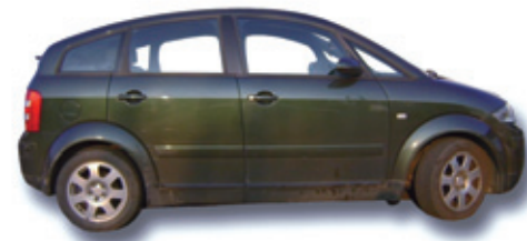
Audi A2 con chasis autoportante en aluminio (cedida por Robotiker Tecnalia)
