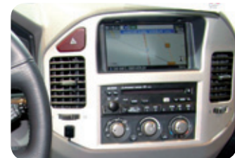
▲ Vehículo que en su pantalla integra las funciones de navegador, información del sistema multimedia y climatización. (cedida por Robotiker Tecnalia).
