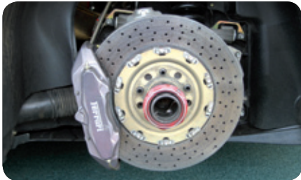
Disco de freno cerámico. ► Fuente: Wikimedia Foundations Inc, licencia Creative Commons Attribution ShareAlike 3.0 (autor The359).
