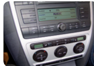
▲ Consola con dos pantallas; una para la climatización y otra para el sistema multimedia (cedida por Robotiker Tecnalia).
