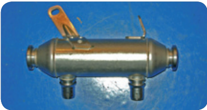
▲ Intercambiador en sistema EGR (cedida por Robotiker Tecnalia).
