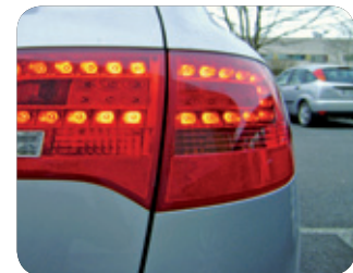
Faro de coche con LED (cedida por Robotiker Tecnalia).
