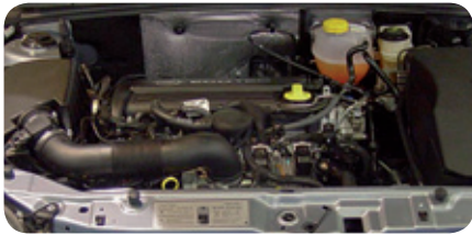
Ejemplo de Vano motor con motor ECOTEC del fabricante Opel (cedida por Robotiker Tecnalia).
