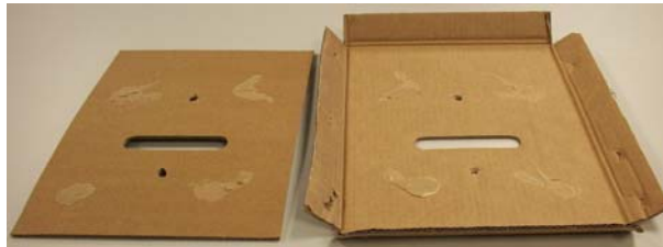
Figura 3 Doble capa de las caras laterales del envase del operador
