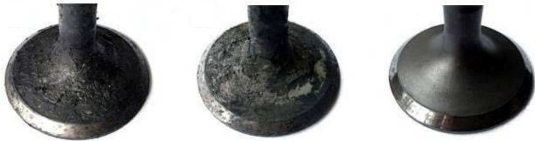
Figura 8 Limpieza de una válvula de motor: pieza a remanufacturar (a), limpieza supercrítico (b), supercrítico + limpieza con agua a alta presión (c).
