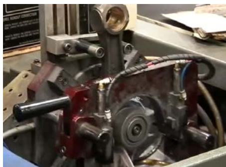
Figura 63.- Operación de mandrinado en la biela
