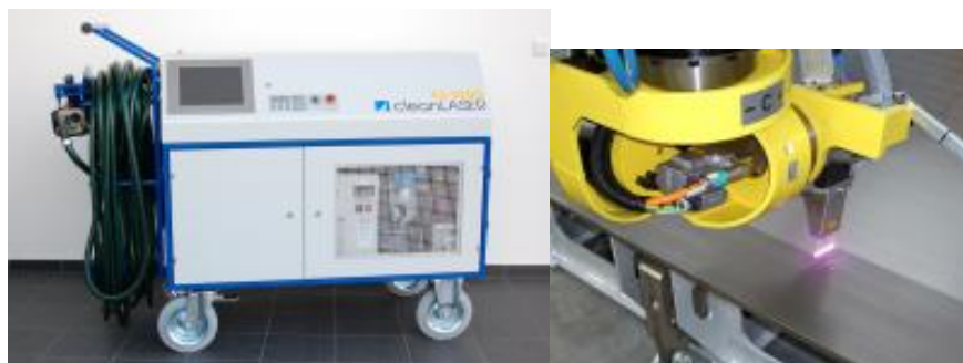
Figura 10 Equipamiento de la limpieza por láser: equipamiento portable (a) y equipamiento fijo (b)
