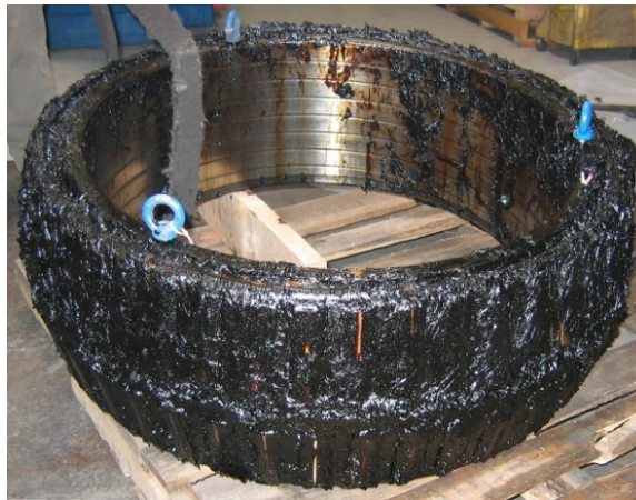
Figura 50.- Rodamiento sucio con grasa
