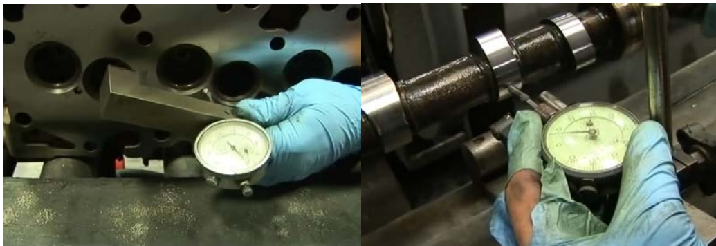
Figura 64.- Inspección de calidad: bloque motor (a), árbol de levas (b)
