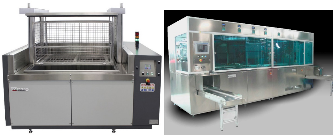
Figura 9.- Equipamiento de la limpieza por ultrasonidos: Equipamiento básico (a) y equipo automatizado (b)
