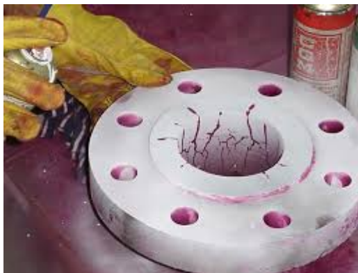
Figura 22.- Ejemplo de defectos (líquidos penetrantes)
