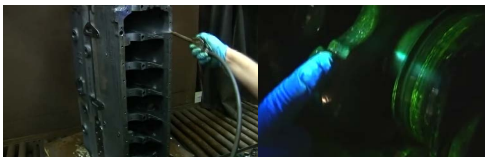
Figura 60.- Inspección mediante partículas magnéticas: bloque motor (a), cigüeñal (b)
