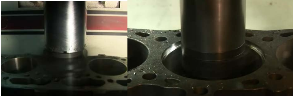
Figura 61.- Reacondicionamiento del bloque motor: rectificado (a), fresado (b)
