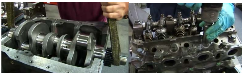
Figura 65.- Ensamblaje del motor: componente remanufacturado (a), componentes nuevos (b)
