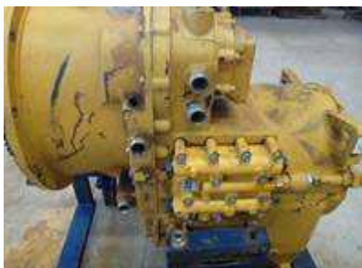
Figura 15.- Pre-limpieza de una caja de cambios (limpieza con agua a alta presión)
