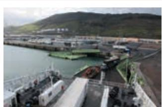
En primer término, carga de una excavadora sobre camión góndola y un remolque con un "tug master" en un buque Ro-Pax
