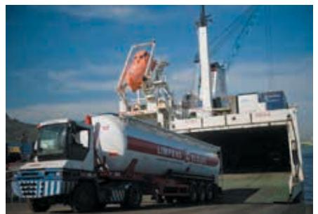
Figura 21.- Descarga de un semirremolque tanque con un tug master
