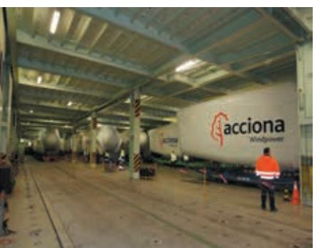
Figura 19.- Roll-trailer con "nacelles" de molinos eólicos embarcados en un buque Ro-Ro sobre Roll-Trailers
