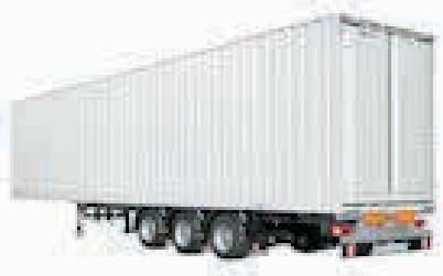
Figura 18b.- Furgón para transporte combinado (terrestre / marítimo). Su diseño está pensado para la protección, reforzando el vehículo para evitar cualquier daño o impacto durante su transporte en barco, con una tara muy ventajosa
