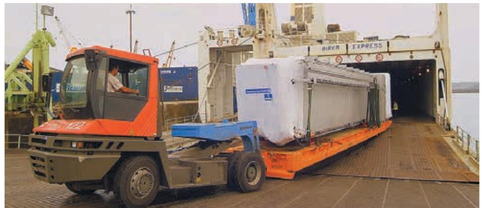
Figura 15a.- "Finger" de aeropuerto sobre un "rolltrailer", empujado por una tractora, entrando en la bodega de un buque Ro-Ro
