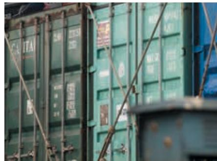
Los contenedores se aseguran (trincan) entre ellos y a los puntos de anclaje del buque.
