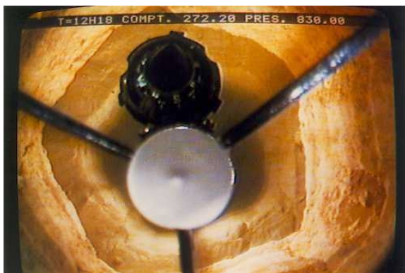
Foto 12 (272,2 m). Contacto entre las dolomías del Danés y las areniscas del Maastrichtiense
