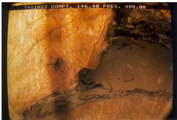
Foto 8 (146,4 m). Vista lateral de un plano de estratificación. Depósito de arenas sobre las irregularidades
