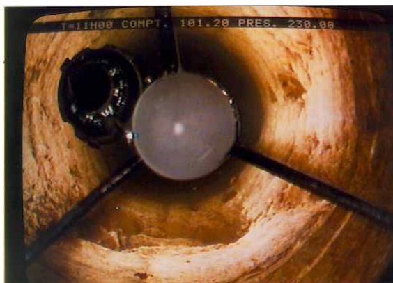
Foto 5 (101,20 m). Pequeña diaclasa y plano de estratificación
