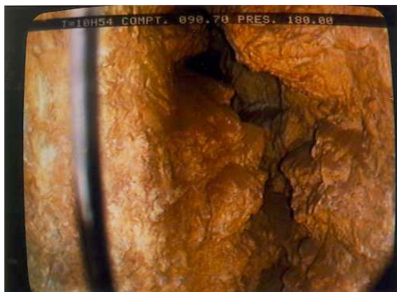
Foto 4 (90,70 m). Vista lateral de la diaclasa N-100-E. Se observan depósitos de arcilla y arena
