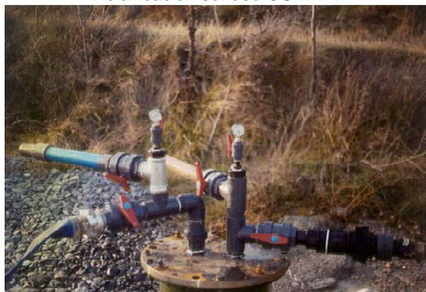
La máxima presión en el cabezal de inyección se produce en el último tapón, alcanzándose 6 Kg/cm<sup>2</sup>.
