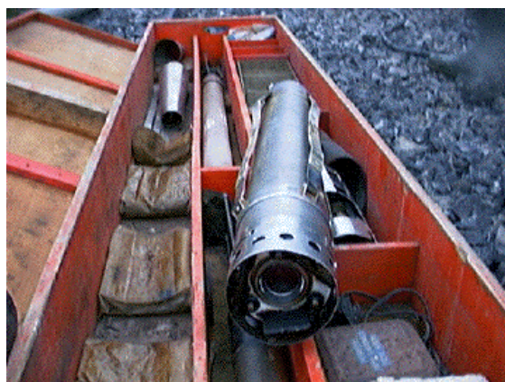
Cámara utilizada en la inspección endoscópica.
