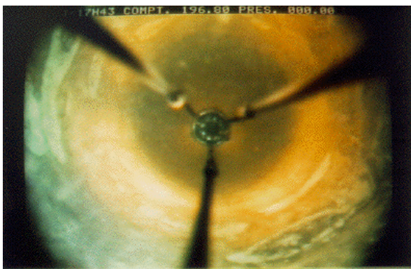
Foto 6 (196.8 m)-Caliza masiva. Sección regular con detalles de los nódulos de sílex característicos.
