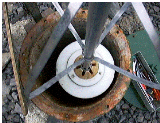
Sonda de flujo-temperatura-conductividad equipada con campana amplificadora y centrador superior.
