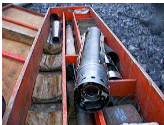
Cámara utilizada en la inspección endoscópica.
