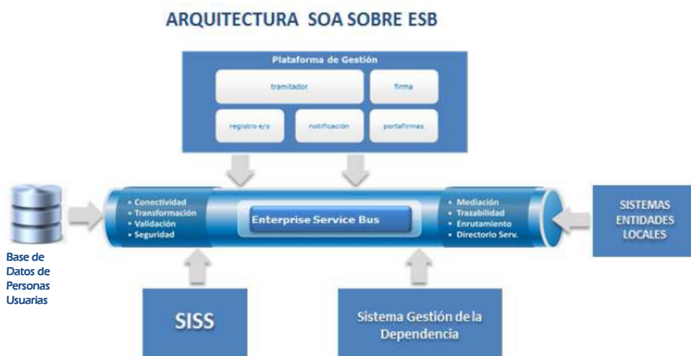
Fig. 9.- Arquitectura Orientada a Servicios (SOA) sobre Bus de Servicios Corporativos (ESB)
