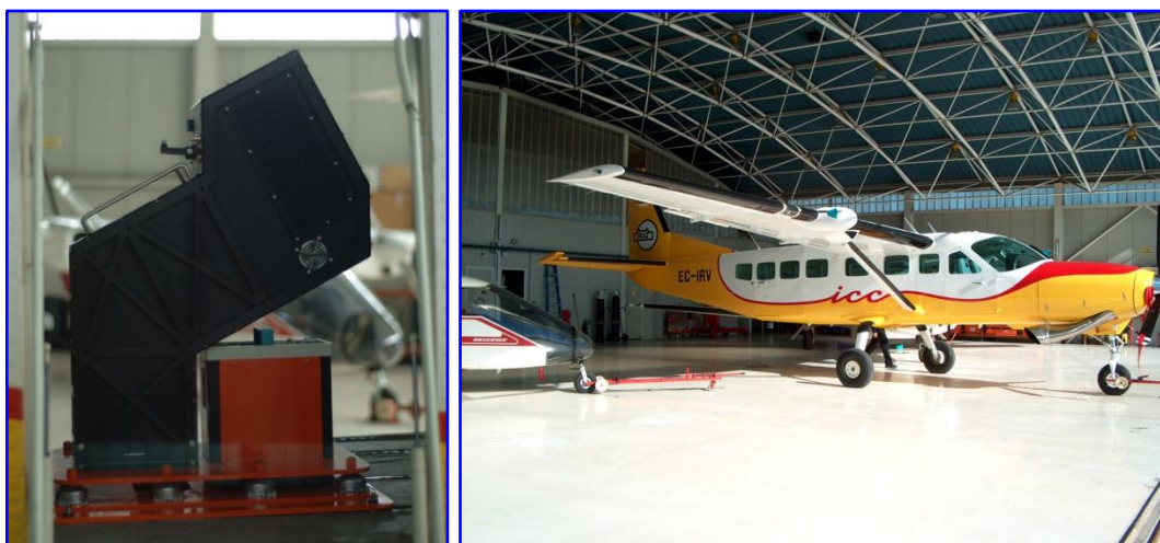
Figura 95. Sensor CASI y avión Cessna Grand Caravan 208B, propiedades del ICC.
