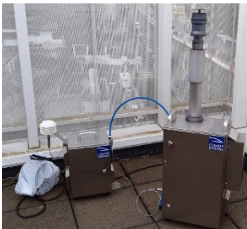
15. irudia. Eibarko ospitalean kokatutako Derenda partikula-kaptadorea, iragazki-euskarria eta partikulen laginketarako iragazkia
