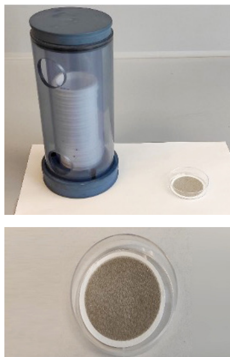
15. irudia. Eibarko ospitalean kokatutako Derenda partikula-kaptadorea, iragazki-euskarria eta partikulen laginketarako iragazkia
