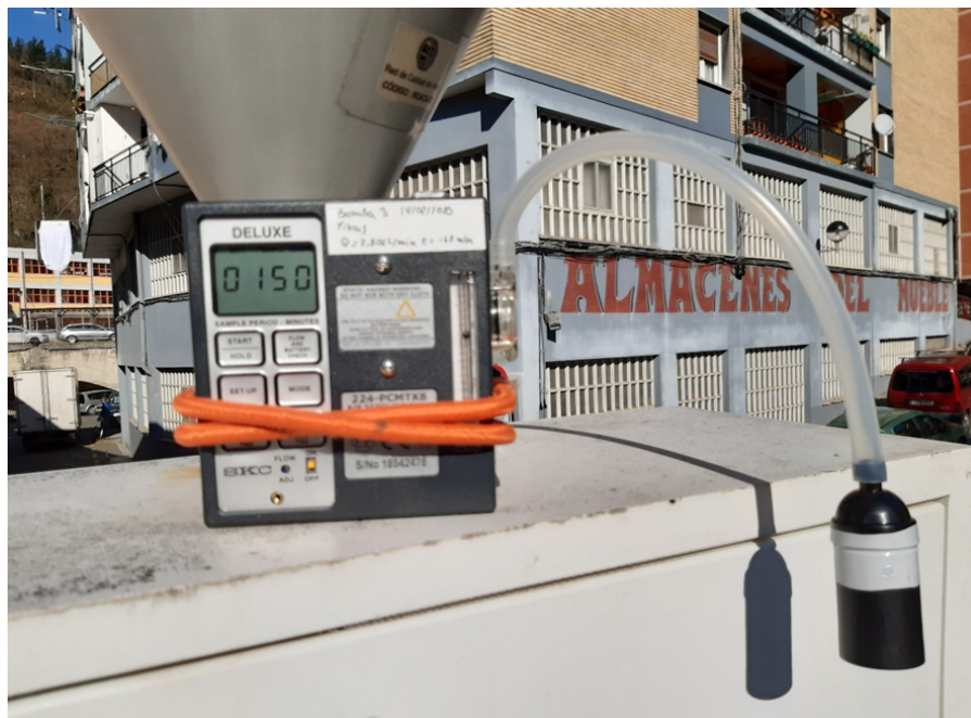
28. irudia. Laginketa-ponpa eta zuntzetarako iragazkiaren prestaketa
