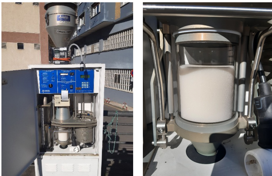
24. irudia: Digitel High Volume partikula-kaptadorea, iragazkiekin eta puff-arekin. Eskuinaldean, poliuretanozko puff-a, kutsatzailea atzemateko
