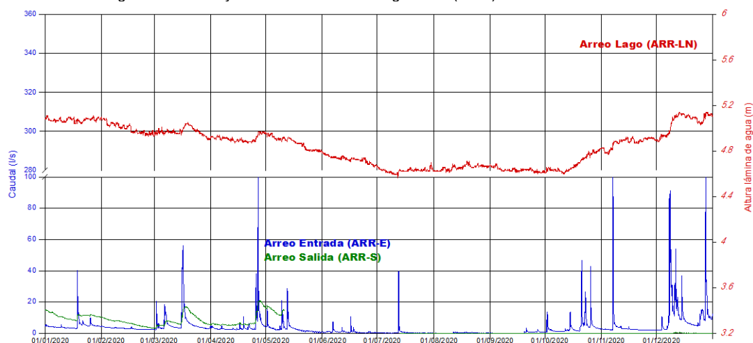
Figura 10 Evolución gráfica del nivel y de los caudales en el lago Arreo (2020).
