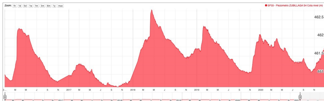
Figura 11 Evolución piezométrica en el punto de control SP33-Piezómetro Zubillaga S4.
