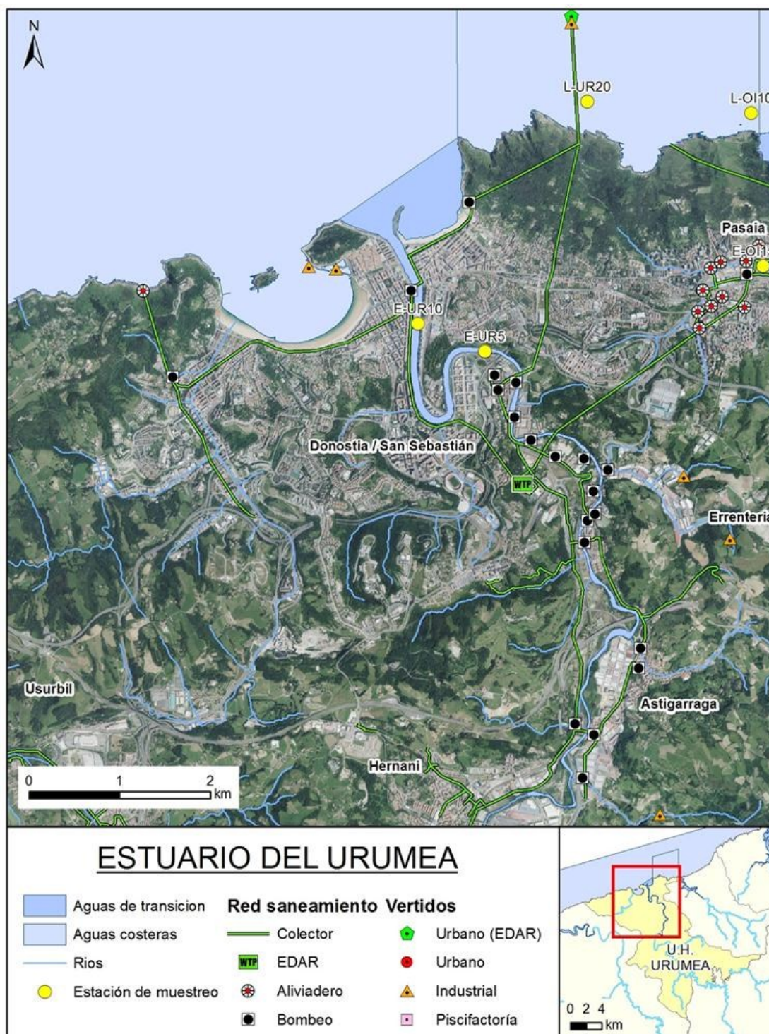
Figura 39 Estaciones de muestreo de la 'Red de Calidad' y localización de los principales vertidos autorizados en la masa de agua de transición del Urumea (Fuente: base de datos DKT, Datuen Kargarako Tresna, Herramienta informática para la carga de analíticas de vertidos de la Agencia Vasca del Agua). Se incluye el esquema de saneamiento (Fuente: Agencia Vasca del Agua).
