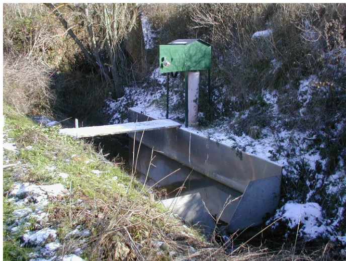
8. irudia Arreo Sarrera ur-emaria neurtzeko estazioa (60°tako hiruki formako isurbideduna).
