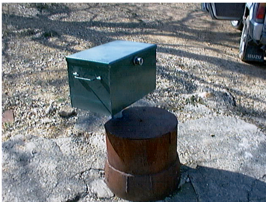
2.2. irudia- Kontrol piezometrikorako estazioa SP02-Orbiso 2 zundaketa
