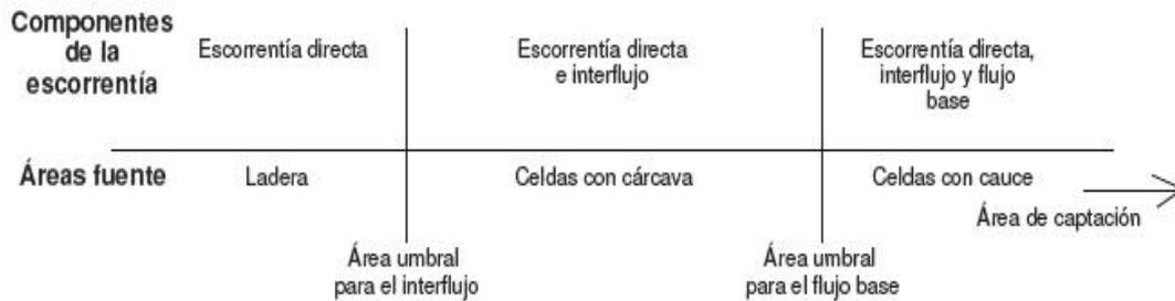
Figura 4. Elementos del sistema, áreas umbrales y componentes de la escorrentía (tomado de Montoya 2008).
