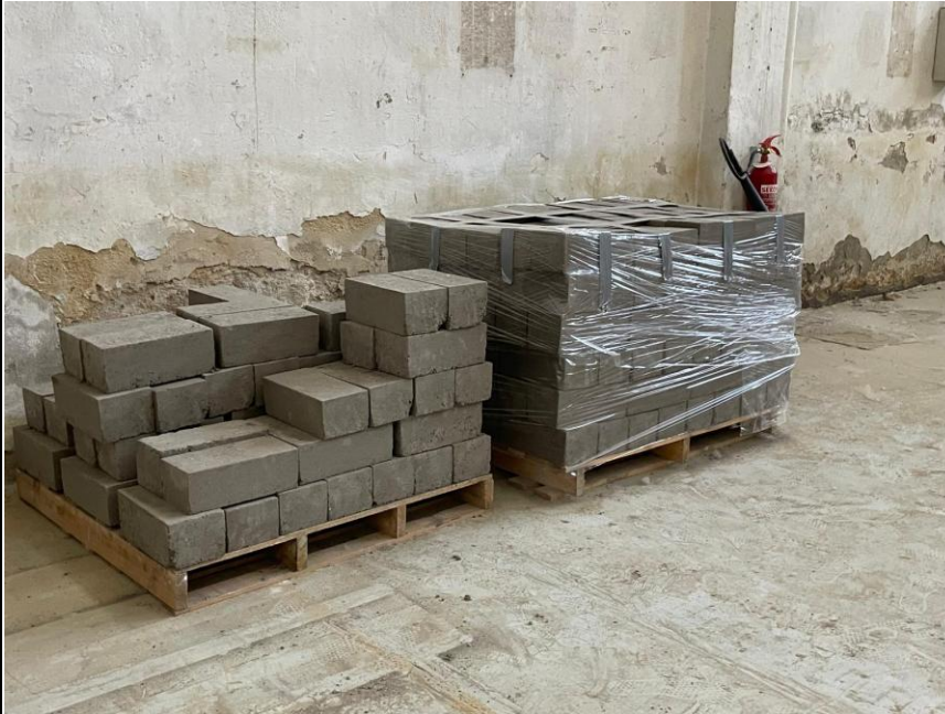
BTEC fabricados durante la fase de pruebas, en proceso de fraguado.
