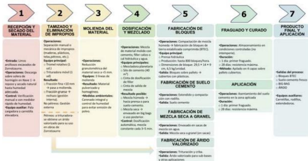
Figura 4. Diagrama del proceso productivo (Información facilitada por el cliente).
