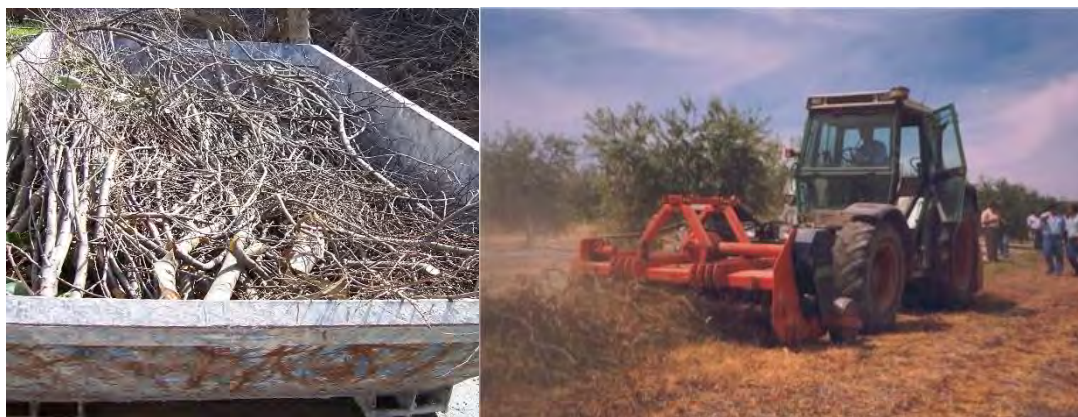
Acopio de ramaje procedentes de desbroces en obra, y trituradora forestal triturando los restos de poda y desbroce
