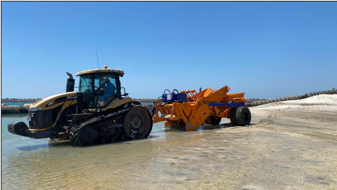
Foto II.4. Tractor de oruga tirando de despedregadora (03-05-2023).
