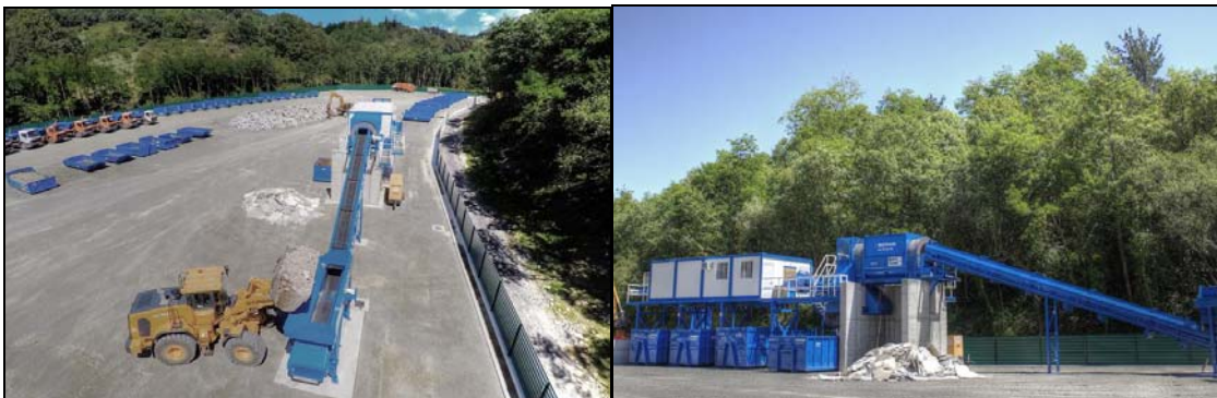
Figuras 58-59. Cadena de tratamiento de residuos de construcción y demolición.
