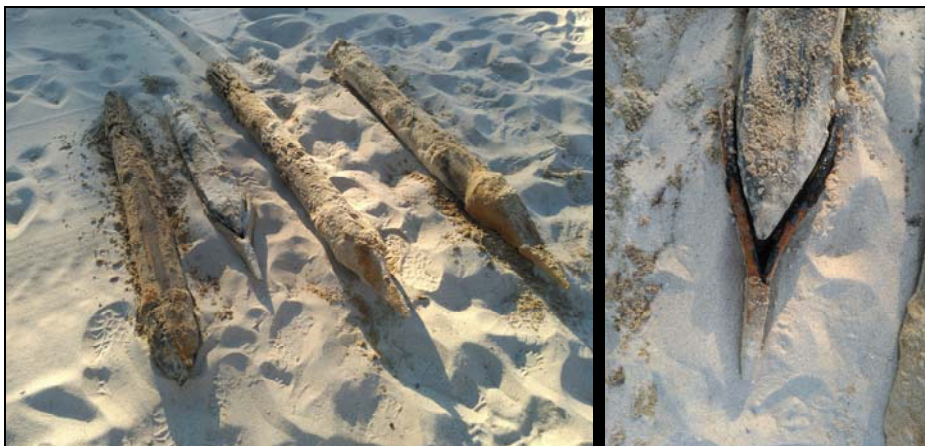
Figura 37 a y b. Estacas con cuña metálica de penetración.
