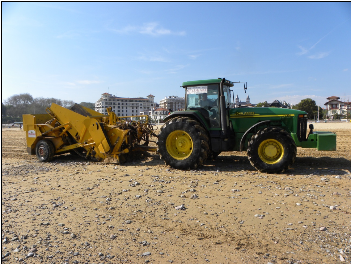
Figura 82. Despedregadora adecuada para la limpieza de cascotes de las playas.
