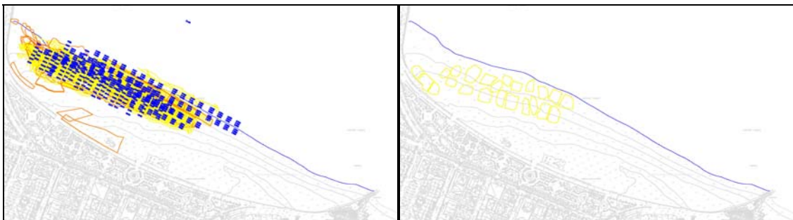
Figuras 47-48. 2020-2021. Izda: Recogidas. Trazado del tractor-despedregadora, limpiaplayas y utilización puntual de miniretro, con lugares de volcado de dicha retirada. Dcha: Devolución de arena.
