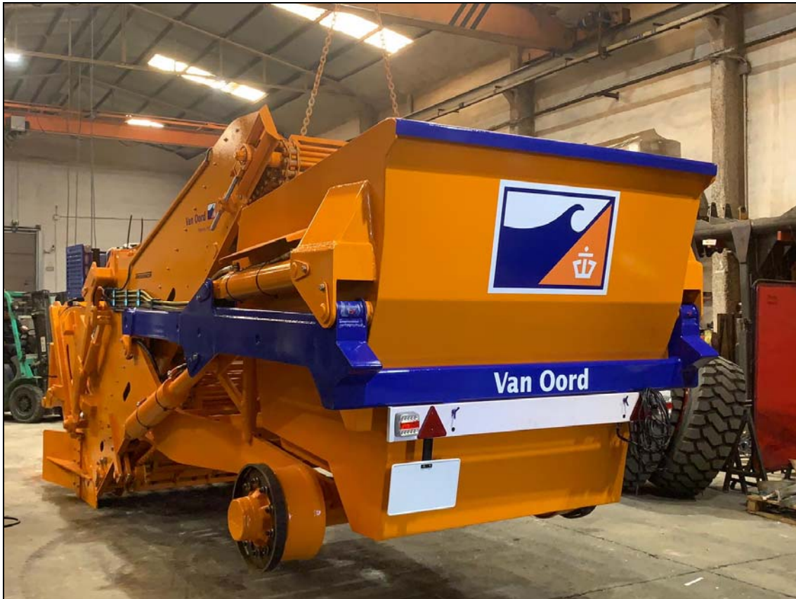
Foto II.3. Despedregadora en construcción en los talleres de Triginer (30-03-2023).
