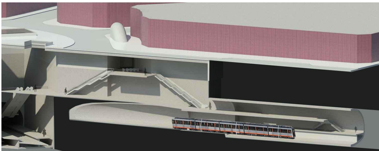
SECCIÓN LONGITUDINAL: LÍNEA 1 Y VESTÍBULO DE CONEXIÓN
