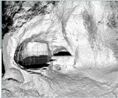
Fig.29. En la imagen de la izquierda vemos el modelo 3D obtenido con el láser terrestre. A la izquierda a ese mismo modelo se le han aplicado los valores RGB de las fotografías.
