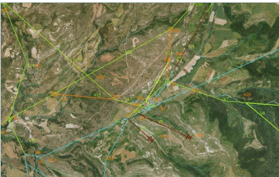
Fig.25. Aparente falta de coincidencia planimétrica entre los datos vectoriales y la información rúster.
