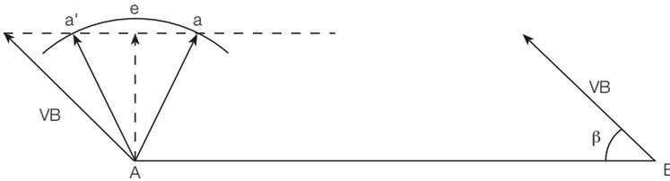
Si  $V_A = A_e$ , el RA es perpendicular a la paralela al rumbo relativo, y la solución es única, dando alcance con la menor velocidad posible, porque si desarrollamos menor velocidad el caso no tendrá solución. Si  $V_A > A_e$  el problema tiene dos soluciones. Si no se indica nada se elegirá como  $RA = Aa$  por ser la que da mayor velocidad relativa y por tanto menor tiempo de alcance.
