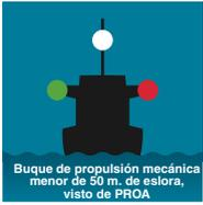
Buque de propulsión mecánica menor de 50 m. de eslora, visto de PROA
