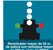
Remolcador mayor de 50 m. de eslora con remolque mayor de 200 m. visto de PROA
