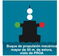
Buque de propulsión mecánica mayor de 50 m. de eslora, visto de PROA
