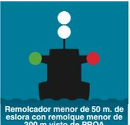
Remolcador menor de 50 m. de eslora con remolque menor de 200 m. visto de PROA
