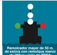
Remolcador mayor de 50 m. de eslora con remolque menor de 200 m. visto de PROA
