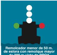
Remolcador menor de 50 m. de eslora con remolque mayor de 200 m. visto de PROA
