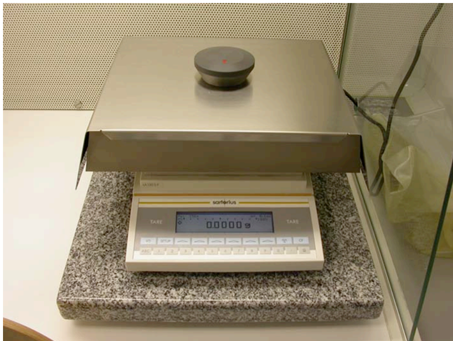
Figura III.7. Aspecto de la balanza de 5 cifras Sartorius utilizada para pesar los filtros estudiados. La balanza se encuentra en una cabina de flujo laminar horizontal dentro de un laboratorio presurizado con temperatura y humedad constantes (sala blanca).
