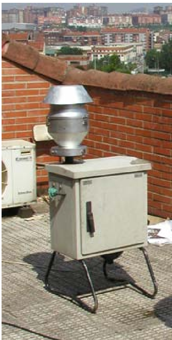
Figura III.6. Aspecto del muestreador de alto volumen MCV empleado en la recolección del material particulado PM2.5 en la localidad de Basauri.
