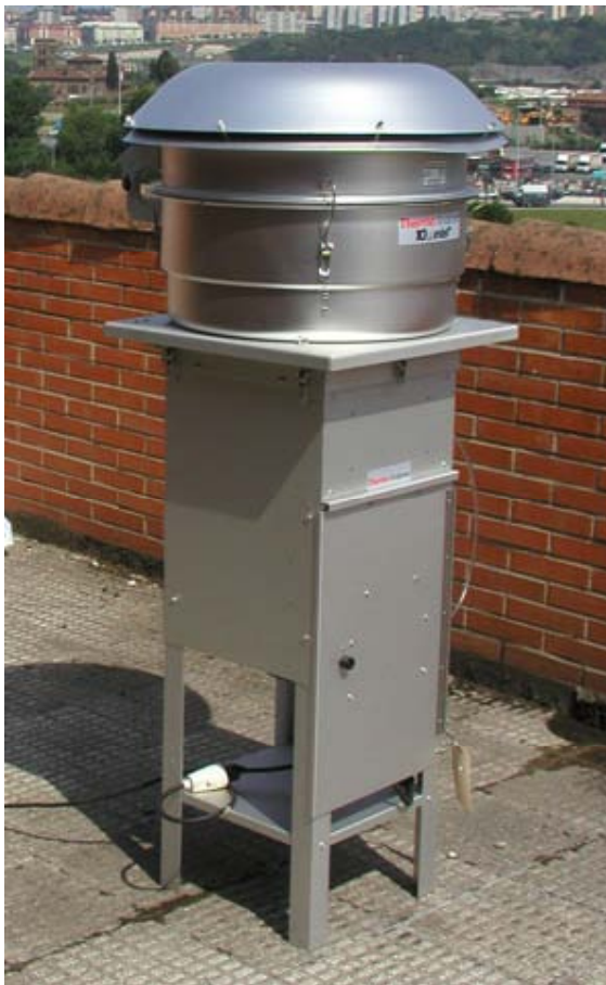
Figura III.5. Aspecto del muestreador de alto volumen Thermo-Andersen empleado en la recolección del material particulado PM10 en la localidad de Basauri y esquema del funcionamiento de dicho muestreador (cf. texto).
