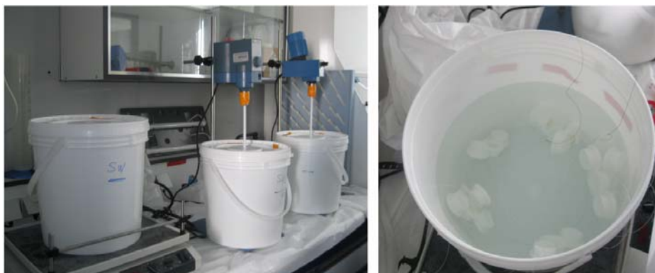
Figura 6. Diseño experimental de los reactores y los agitadores orbitales (izquierda). DGTs sumergidos en uno de los reactores (derecha).
