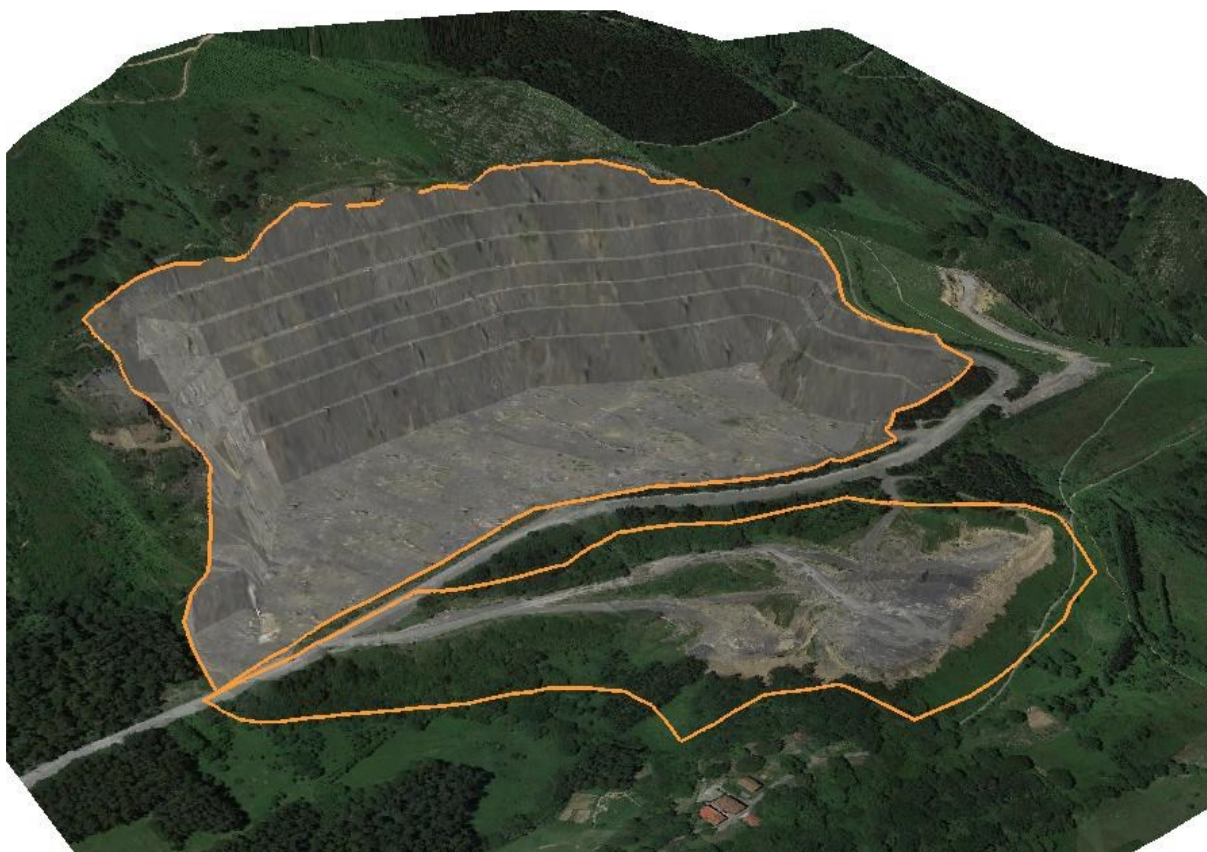
Figura 21. Plan de explotación aprobado. Situación final (7 bancos)
