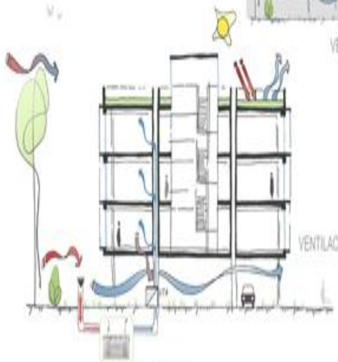
POZOS CANADIENSES COMO APOYO A LA RENOVACIÓN DEL AIRE
