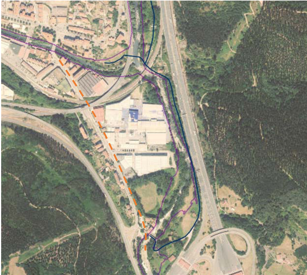
Ortofoto 4: L1.2. Urbi-PLN, en confluencia Nerbioi y Altube, cruce sobre el río en ZFP y trazado complicado, entre confluencia y peaje de la autopista, entre ésta y el río, invadiendo zona de servidumbre. Trazado sugerido en naranja con trazo discontinuo.
