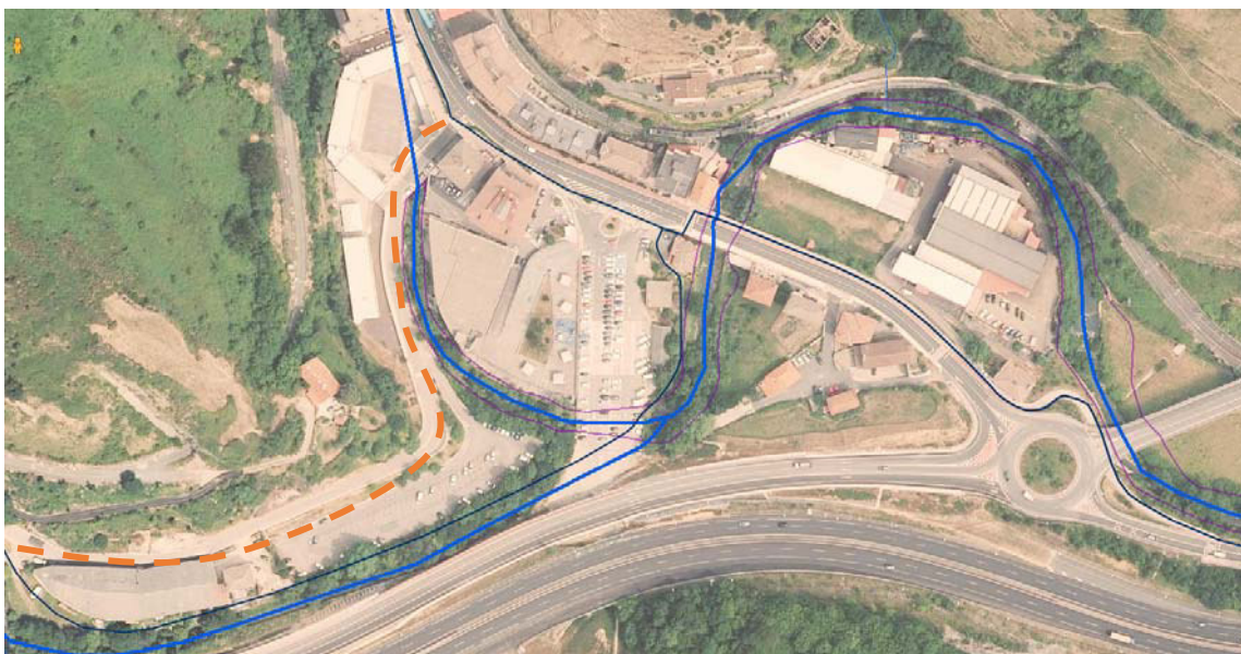
Imagen 5: Línea 1.10 Zaldibar-Ermua, en Sallobenta, trazado por servidumbre de protección del río y cruce del Ego bajo una cobertura. Trazado sugerido en naranja con trazo discontinuo.
