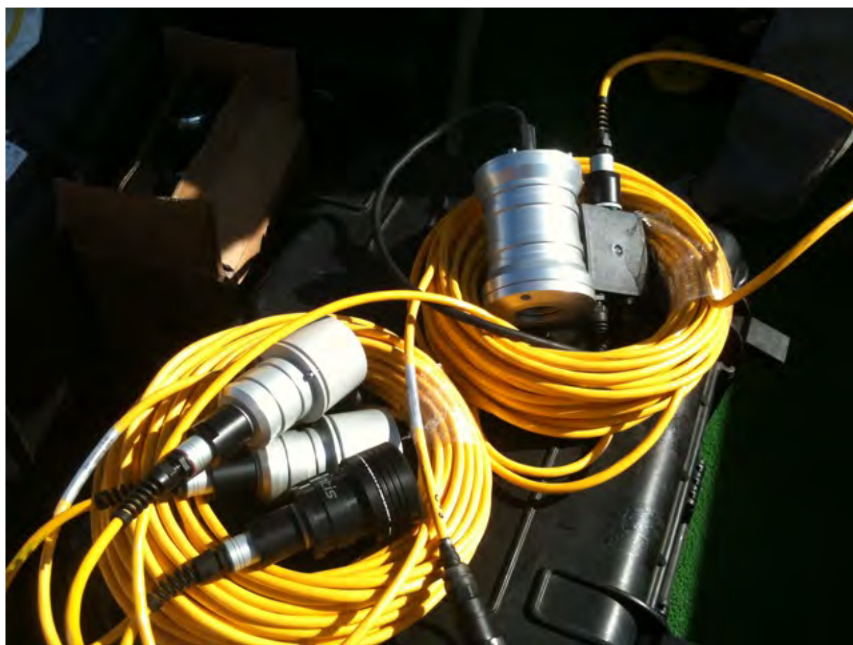
Figura 5: detalle de las cámaras y sensores submarinos antes de su instalación.
