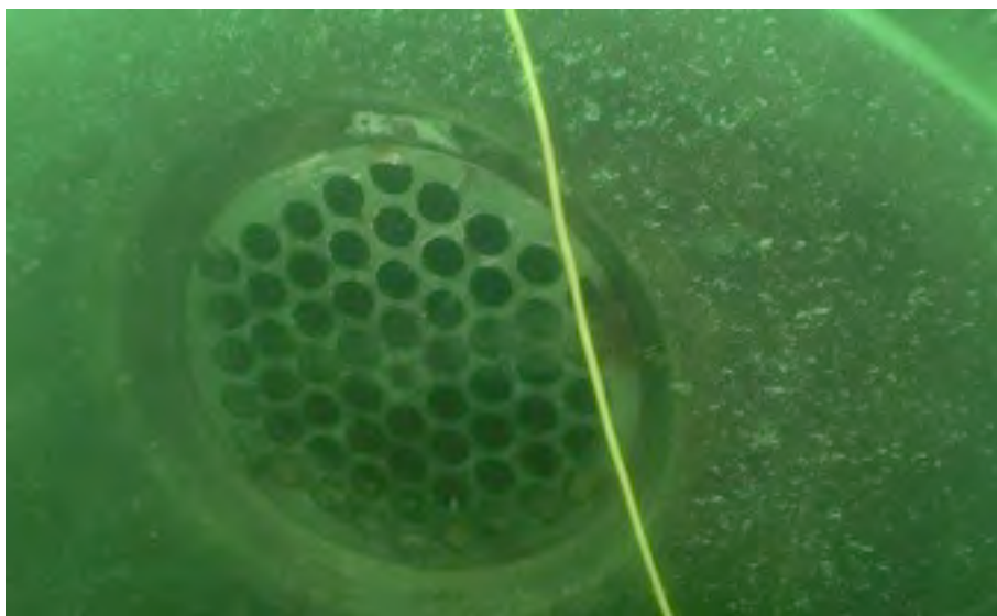
Cambio de la ventana por reja con orificios de acero. Detalle lateral del módulo que muestra su colonización por microalgas y poliquetos serpúlidos.
