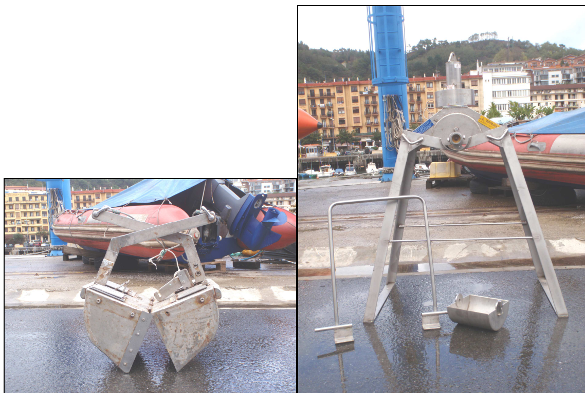
Figura 6. A la izquierda, draga tipo Van Veen; a la derecha, draga tipo Shipek con todos sus componentes asociados.
