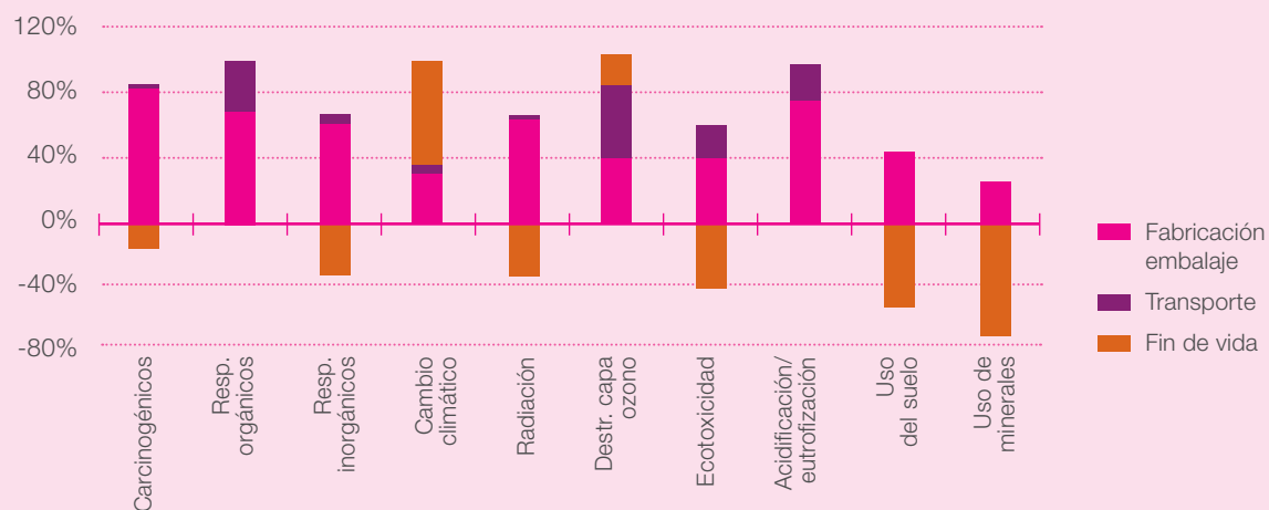
Análisis del ciclo de vida del sistema de envase ecodiseñado
