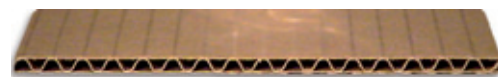
▲ Espesor de una caja de cartón ondulado después de aplicar la medida (elaboración propia)
