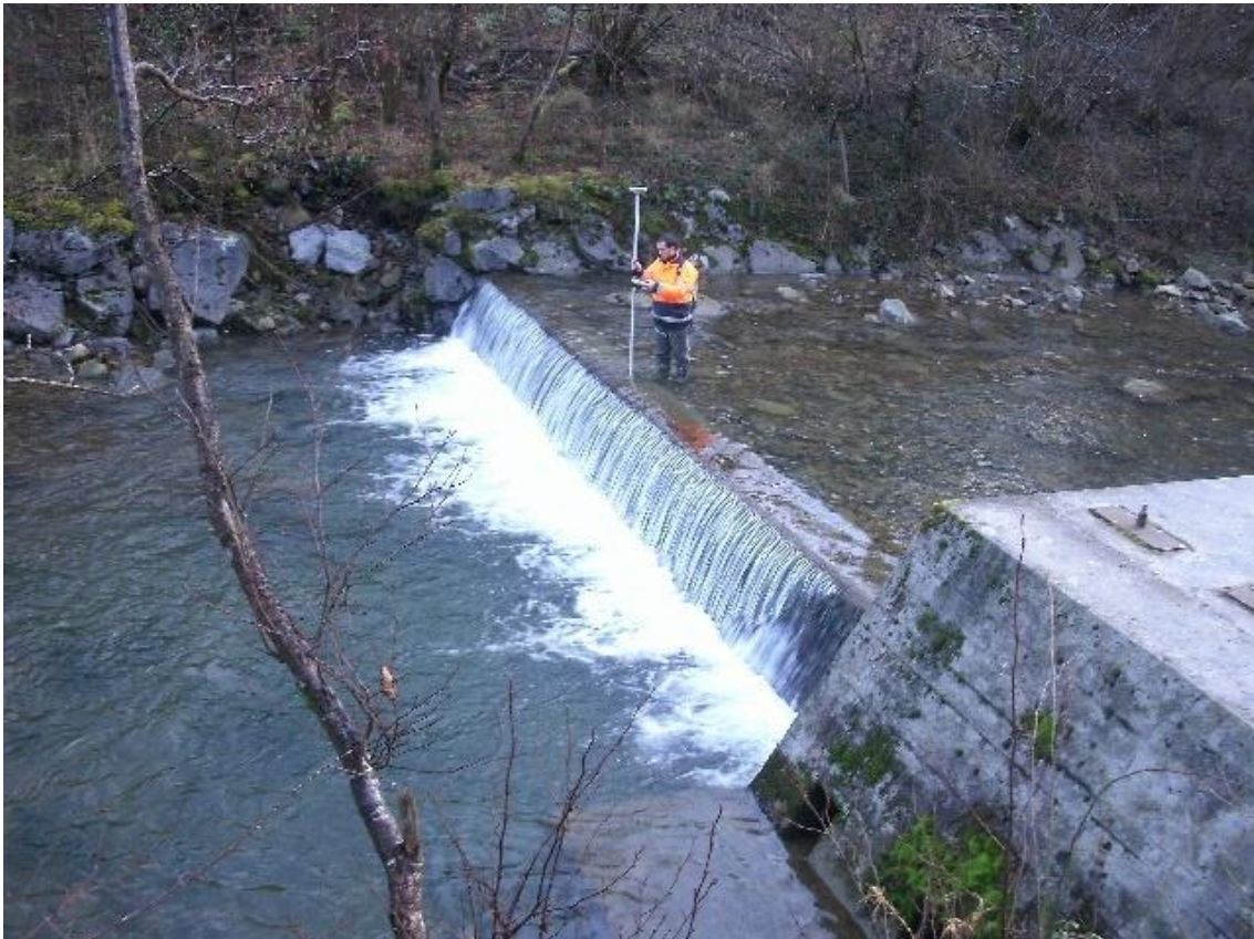
Figura 32. Ejemplo de perfiles realizados mediante GNSS-RTK vadeando el río.
