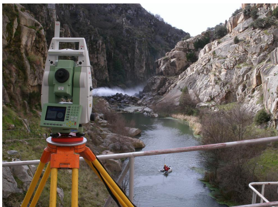
Figura 36. Ejemplo de perfil realizado mediante Estación Total embarcación y ecosonda.
