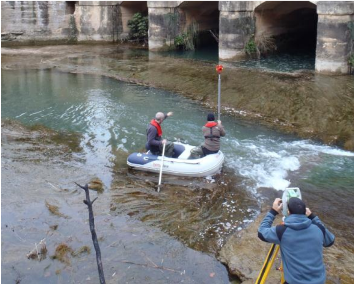
Figura 37. Ejemplo de perfil realizado mediante Estación Total embarcación y jalón.
