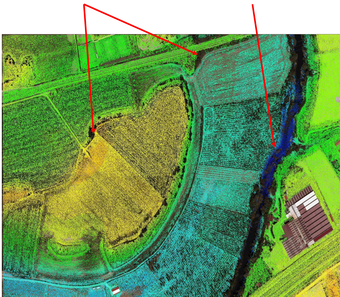
Figura 16. Ortofoto y nube de puntos LIDAR. Puntos clasificados como “Suelo”.
