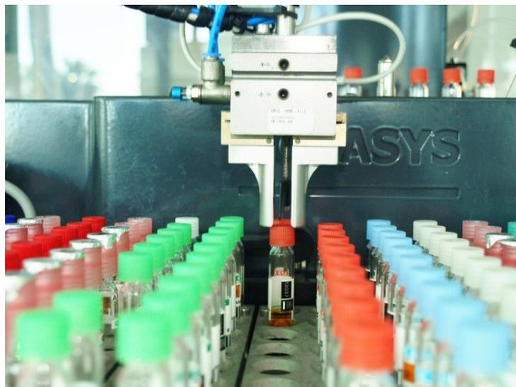
Foto 5. Robot para análisis químico de muestras de agua (Foto Laboratorios Levante).
