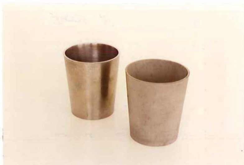
4.6 irudia.- Erreminta-altzairu lasterreko hautsez enbutizio sakonaz lortutako ontziak (a) Moldetik zuzenean aterata (b) Lotzaile organikoa atera eta ondoren sinterizatua izan dena.
